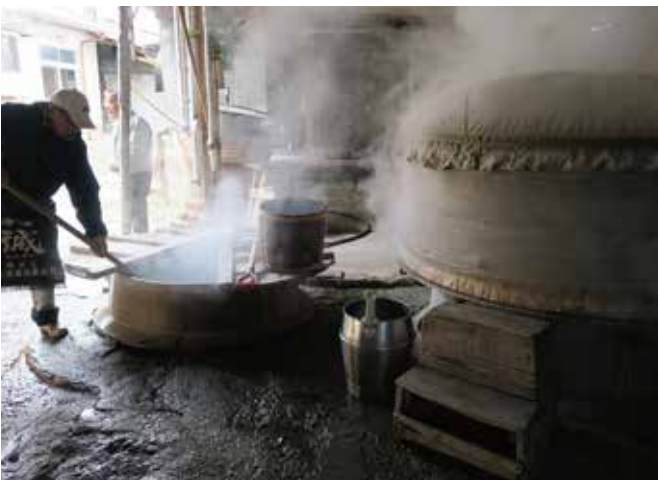
▲蒸し上げられた酒米を冷ます「放冷」。手造りにこだわる吉良酒造では、むしろの上に広げて外気で自然冷却する昔ながらの方法をとっている
